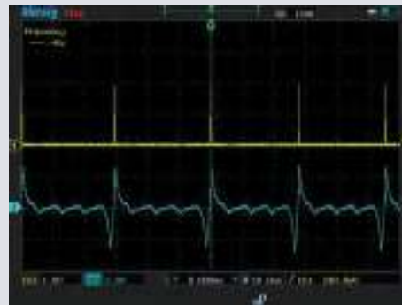
3 Oscilogram tyristorového zapalování JTZ.
