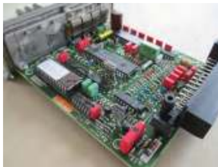
5 Jednoduchá řídicí jednotka Bosch Motronic M1.x, kterou lze snadno opravovat. Alespoň do doby, dokud bude odkud „brát“ součástky.
