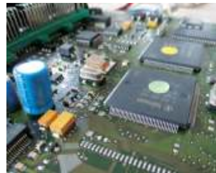
6 Řídicí jednotka Bosch Motronic ME7 – jednoduše opravitelná s relativně běžnými komponentami.
