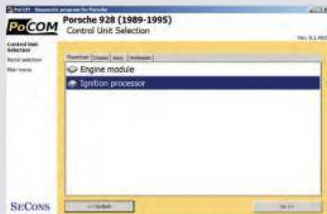
4 Dvě oddělené řídicí jednotky pro motor vozu Porsche 928.
